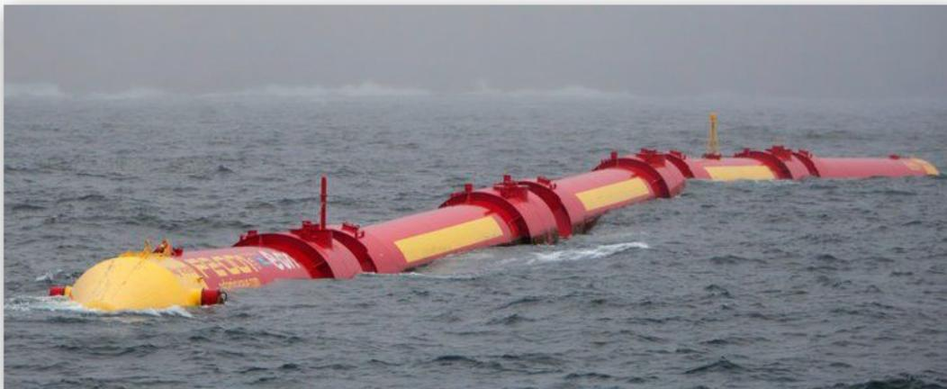
Раскачиваясь на волнах, эти огромные конвекторы («змеи») изгибаются, вследствие чего внутри приходят в движение гидравлические поршни. Они прокачивают масло через гидравлические двигатели, которые в свою очередь вращают электрогенераторы. Полученное электричество доставляется на берег через кабель, который проложен по дну. В перспективе количество конвекторов будет многократно увеличено и станция сможет вырабатывать до 21 МВт.
